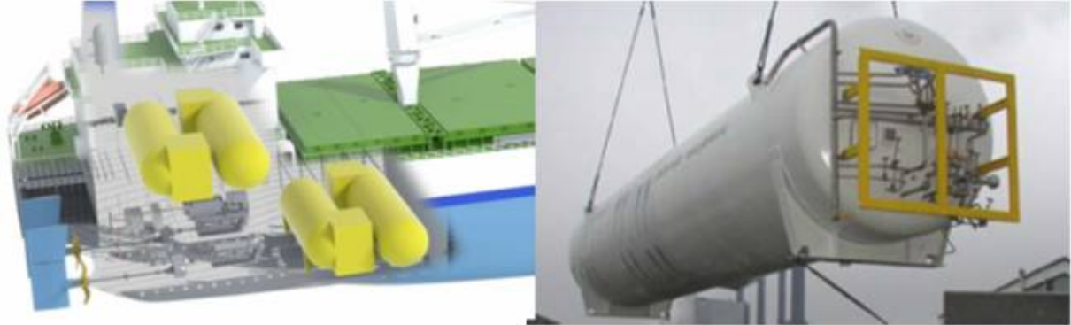
'Type C' LNG fuel Tank
